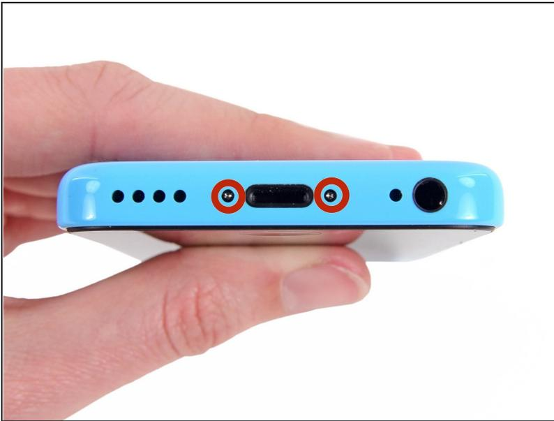
**⚠** Prima di iniziare, scarica la batteria dell'iPhone sotto il 25%. Una batteria al litio-ioni può incendiarsi e/o esplodere se viene forata accidentalmente.
