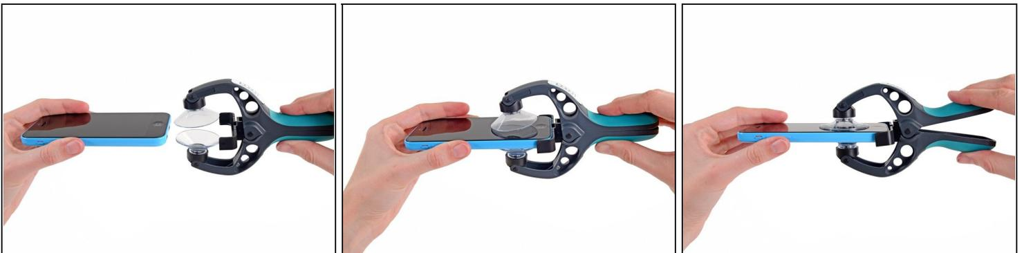
**i** I prossimi due passi mostrano l'uso dell'[iSclack](#), un ottimo strumento per aprire l'iPhone 5c. Lo raccomandiamo a chiunque debba eseguire più di una riparazione su iPhone 5, 5s o 5c. **Se non intendi usare l'iSclack, salta al [passo 5](#).**
