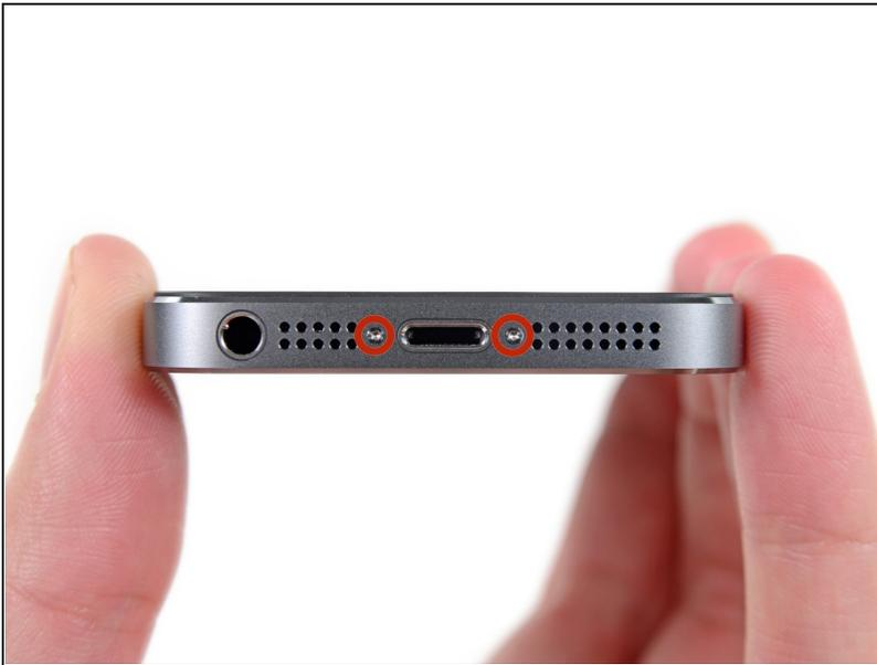
**⚠** Prima di continuare, scarica la batteria del tuo iPhone sotto il 25%. Una batteria al litio-ioni carica può prendere fuoco e/o esplodere se viene forata accidentalmente.
