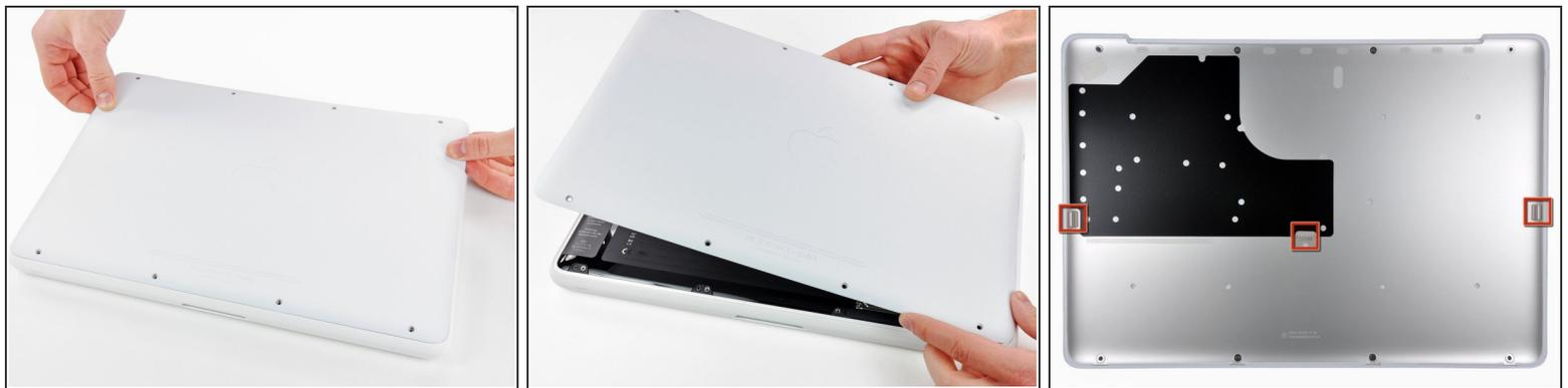
**⚠** La struttura del case inferiore è in alluminio con rivestimento in gomma. Durante la rimozione, non piegare eccessivamente l'alluminio, poiché eventuali deformazioni permanenti causerebbero problemi di tolleranze dopo il riassettaggio.
