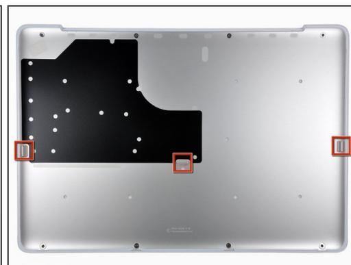
**⚠** La struttura del case inferiore è in alluminio con rivestimento in gomma. Durante la rimozione, non piegare eccessivamente l'alluminio, poiché eventuali deformazioni permanenti causerebbero problemi di tolleranze dopo il riassettaggio.
