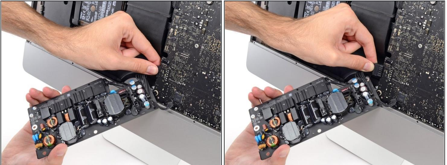
**⚠ Stai molto attento** a non toccare i contatti dei condensatori o qualsiasi saldatura esposta sul retro dell'alimentatore. Tieni la scheda solo dai bordi.
