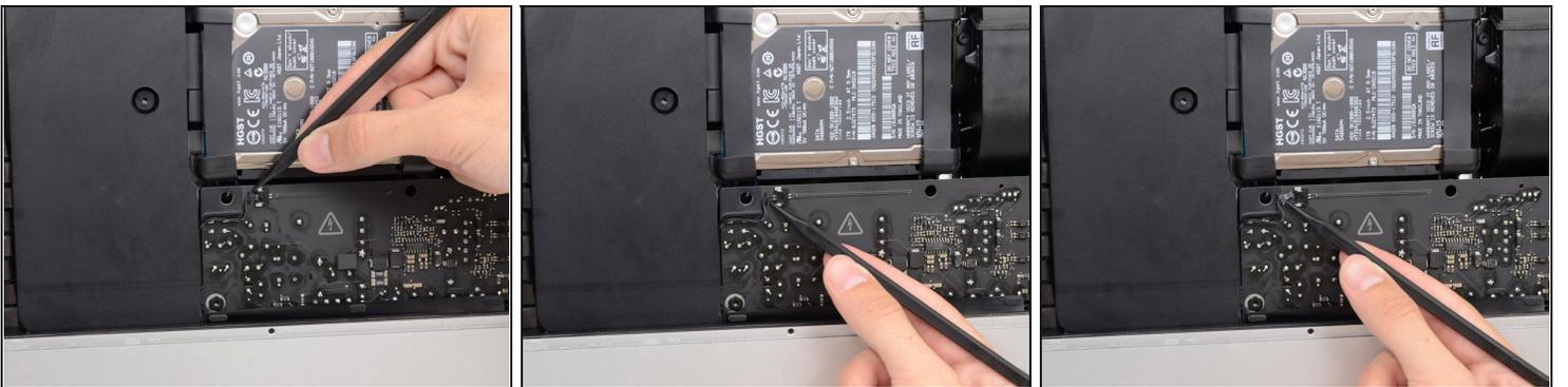
**⚠** I prossimi passi ti porteranno a lavorare vicino alla faccia esposta dell'alimentatore. **Non toccare** la faccia dell'alimentatore per evitare una scossa ad alta tensione dei diversi grandi condensatori saldati alla scheda.
