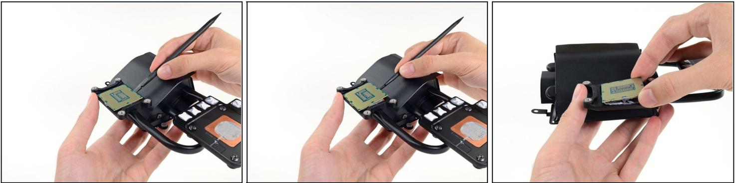
ⓘ La CPU probabilmente sarà incollata al dissipatore tramite la pasta termica.
