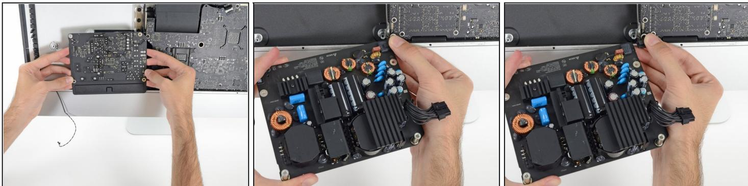
**⚠ Fai molta attenzione** a non toccare i condensatori o qualsiasi saldatura esposta sul retro dell'alimentatore. Maneggia la scheda solo dagli angoli.
