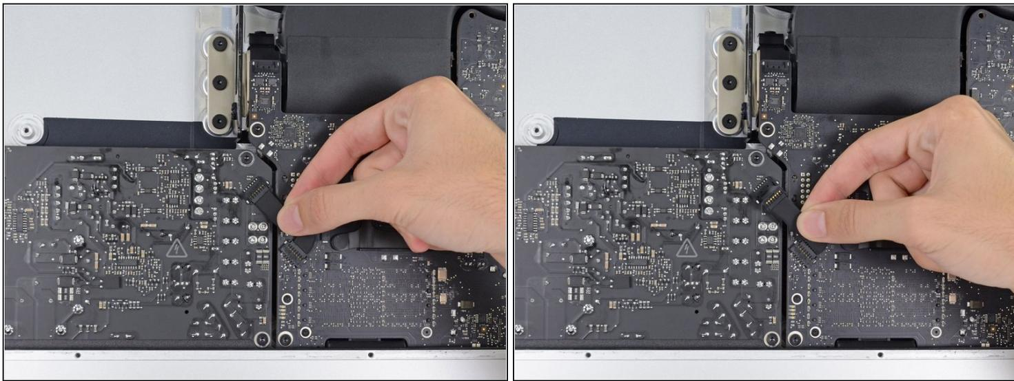
⚠ Quando si lavora sull'alimentatore **fai molta attenzione** a non toccare i contatti dei condensatori o qualsiasi saldatura esposta sul retro dell'alimentatore. Maneggia la scheda solo dagli angoli.
