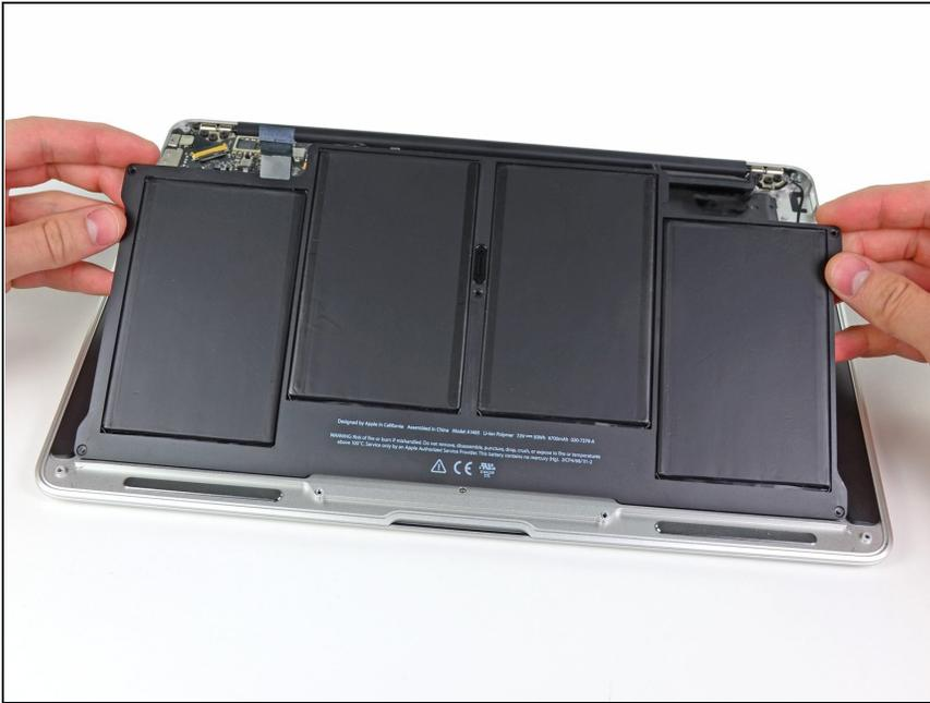
**⚠** Mentre maneggi la batteria, evita di schiacciare o toccare le quattro celle ai polimeri di litio esposte.
