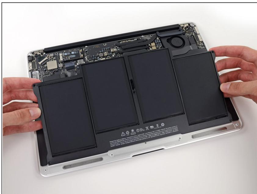
**⚠** Quando maneggi la batteria, fai attenzione a non premere o toccare le quattro celle a polimeri di litio.
