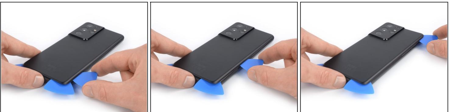
ⓘ Se l'adesivo diventa difficile da tagliare, molto probabilmente si è raffreddato. [Usa il tuo iOpener](#) per due o tre minuti per scaldarlo di nuovo.
