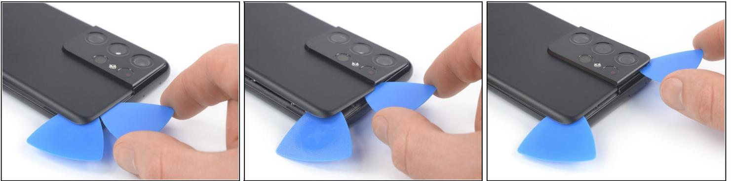
**⚠** Quando tagli vicino al gruppo della fotocamera, inserisci solo la punta del plettro (circa 4-5 mm) per evitare di danneggiare o sporcare la fotocamera.
