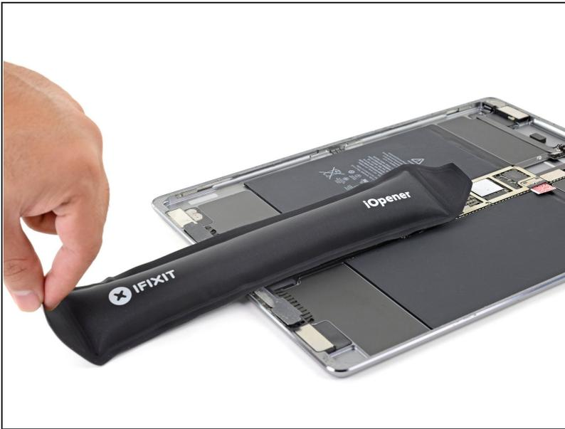
ⓘ Entrambi i cavi dell'antenna sono incollati sul telaio. Puoi ammorbidire l'adesivo con un'iOpener scaldato o dell'alcool isopropilico ad alta concentrazione (>90%).
