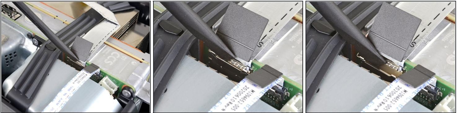
**⚠ I cavi a nastro e i loro connettori sono estremamente delicati, quindi apri sempre le alette di bloccaggio delicatamente e sfilati cavi lentamente.**
