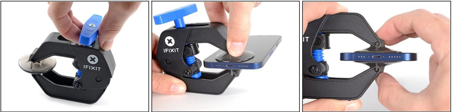
ⓘ I prossimi tre passaggi dimostrano l'uso dell'Anti-Clamp, uno strumento progettato per rendere il processo di apertura più semplice. **Se non stai usando un Anti-Clamp, salta i prossimi tre passaggi per un metodo alternativo.**
