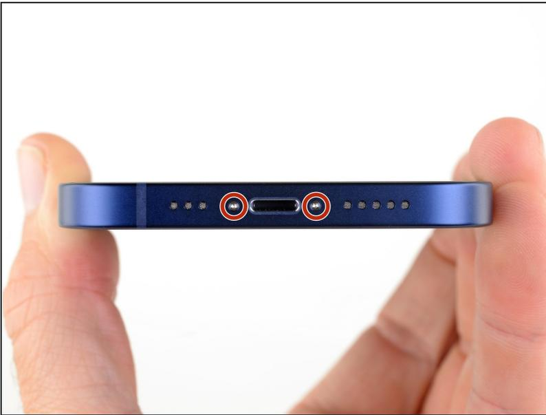
**⚠ Attenzione:** Prima di iniziare, scarica la batteria del tuo iPhone sotto al 25%. Una batteria agli ioni di litio carica può prendere fuoco e/o esplodere se forata accidentalmente.
