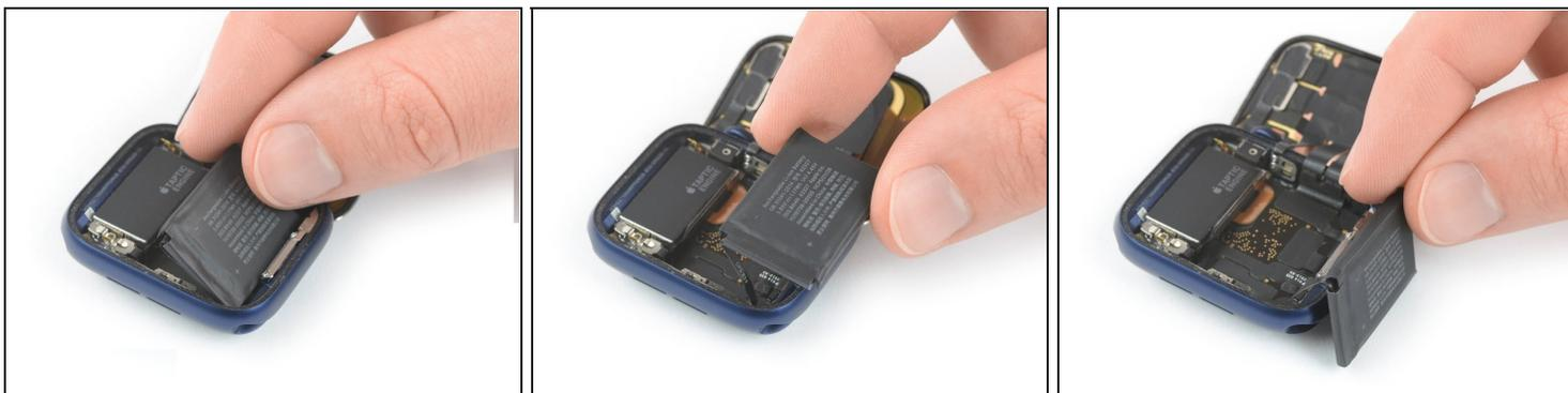
⚠ Il cavo a nastro della batteria è lungo abbastanza da permetterti di appoggiarla fuori dalla cassa dell'orologio durante la procedura, ma evita di tirarlo troppo quando la sollevi dal suo alloggiamento.
