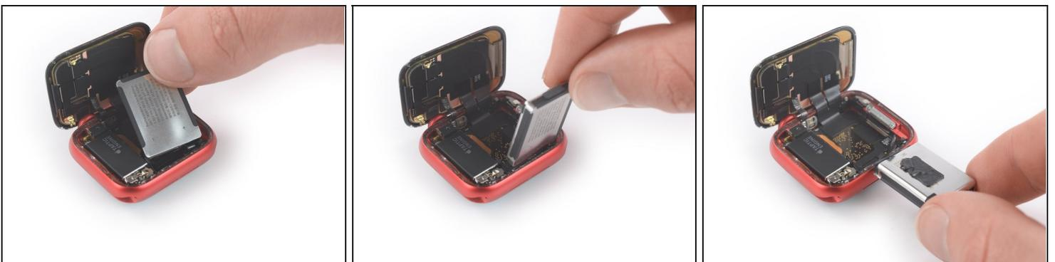
⚠ Il cavo a nastro della batteria è lungo abbastanza da permetterti di appoggiarla fuori dalla cassa dell'orologio, ma evita di tirarlo troppo quando la sollevi dal suo alloggiamento.
