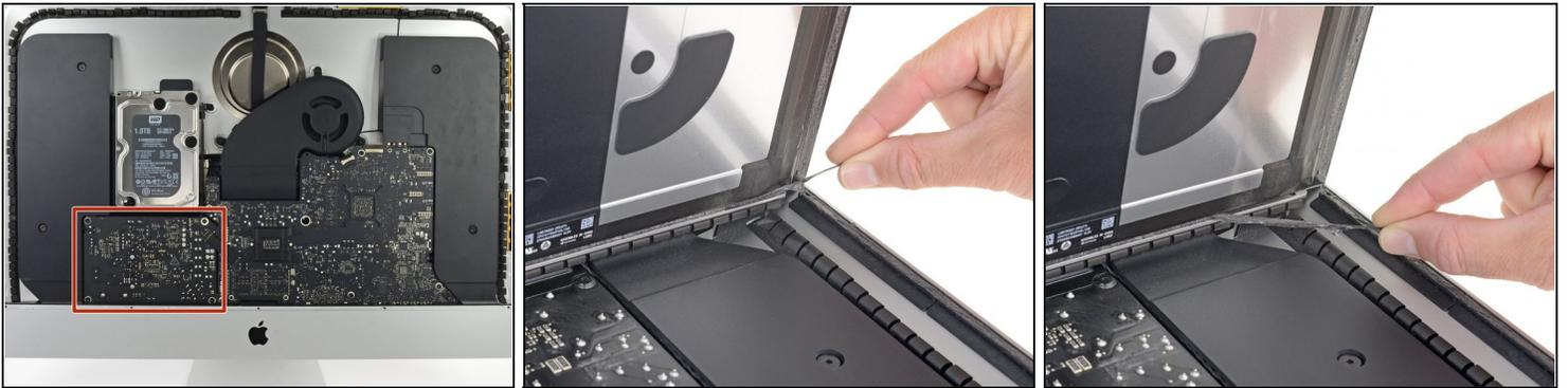
**⚠** Stai molto attento non toccare i capi del condensatore o qualsiasi saldatura esposta sul retro dell'alimentatore (evidenziato in rosso).
