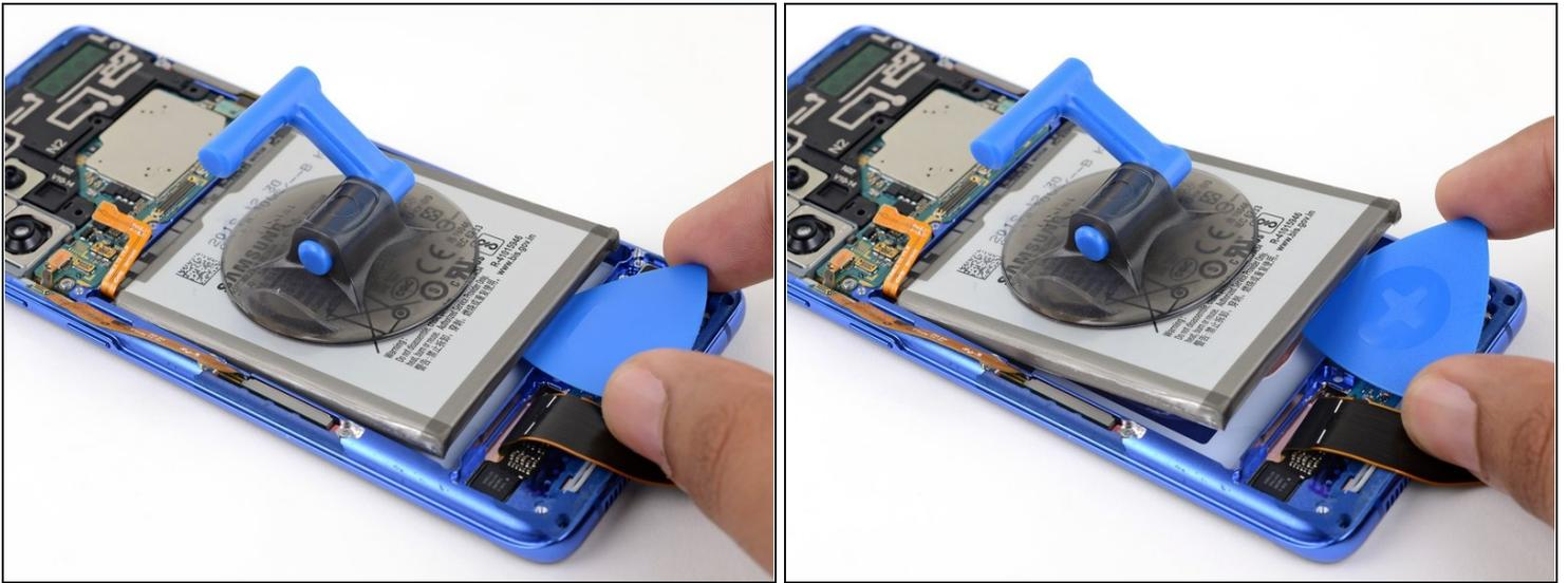
**⚠️ Attenzione:** non continuare con questo passo finché la batteria non è sollevata abbastanza per inserire facilmente un plettro di apertura sotto la batteria. Se la batteria è ancora incollata saldamente in posizione, rischi di forare la batteria con il tuo plettro e causare un pericoloso evento termico.
