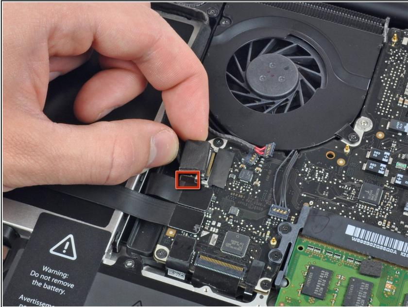
⚠ È necessario spingere via il piccolo fermacavi in plastica (evidenziato in rosso) incollato alla scheda logica prima di scollegare il cavo della fotocamera. Stai attento a non rompere alcun componente della scheda mentre lo allontani dal connettore del cavo della fotocamera.
