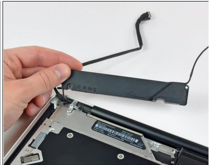
☒ Il subwoofer è ancora collegato all'altoparlante di destra, perciò aspetta a rimuoverlo completamente.
