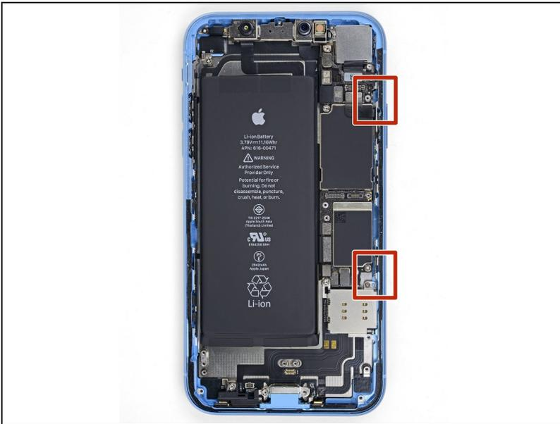
⚠ An der rechten Kante des iPhones verlaufen empfindliche Kabel. **Setze an den markierten Stellen kein Plektrum ein**, du könntest die Kabel beschädigen.
