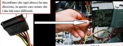
Per quanto riguarda i connettori di alimentazione delle schede madri si ricorda il connettore principale (MAIN) che può essere da **20-pin** oppure da **24-pin** (è necessario contarli), ci può essere anche, come abbiamo visto nelle pagine precedenti, un connettore aggiuntivo da 4-pin disposti a quadrato che ha la funzione di alimentare specificamente il processore (è stato introdotto di Pentium4 in poi).
