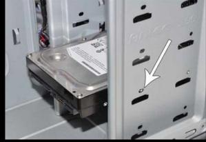
Due viti da un lato e due dall'altro, solitamente in un case di tipo tower gli HD si mettono in basso e i lettori/masterizzatori in alto. Comunque ci sono alloggiamenti già predisposti e della giusta dimensione. Gli alloggiamenti per i dischi sono da 3,5 pollici mentre quelli per le unità ottiche sono 5,25 pollici.
