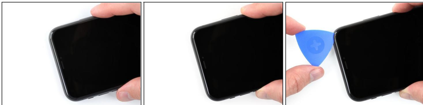
ⓘ Il bordo superiore del display è fissato sia con colla che con clip.
