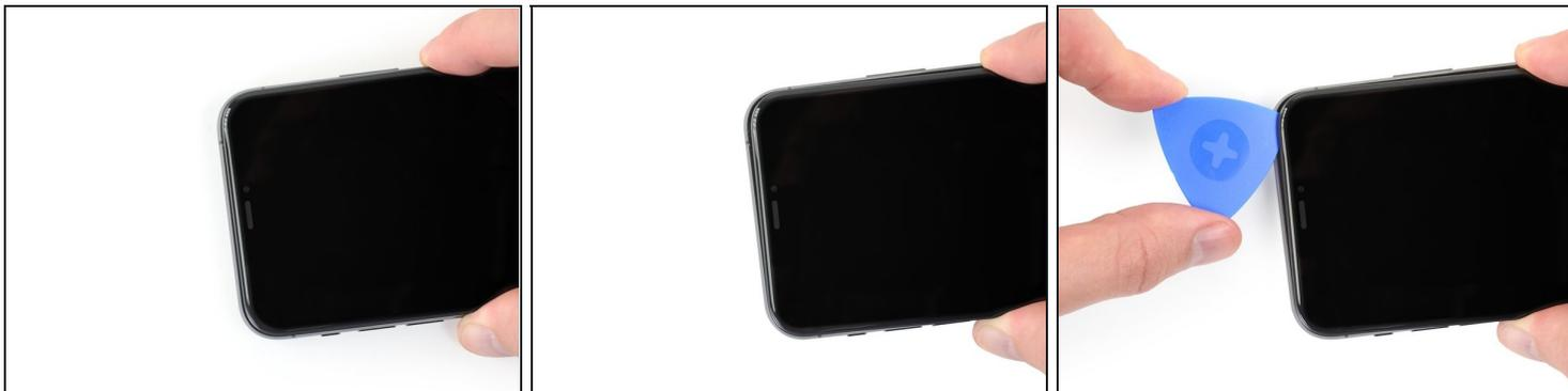
ⓘ Il bordo superiore del display è fissato sia con la colla sia con delle clip.
