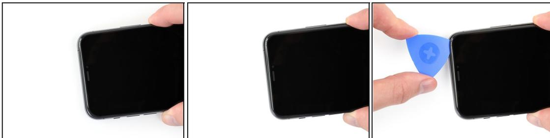
**i** Il bordo superiore del display è fissato sia con la colla sia con delle clip.
