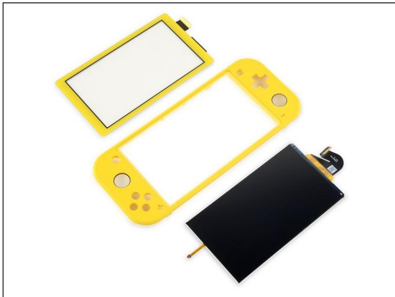
✦ Lo Switch originale aveva uno [schermo non laminato con intercapedine di aria](#): una rarità di questi tempi, ma che rende economico e facile sostituire il vetro rotto. In un dispositivo molto propenso a cadere per terra, questo aiuta parecchio ad abbassare i costi di riparazione.
