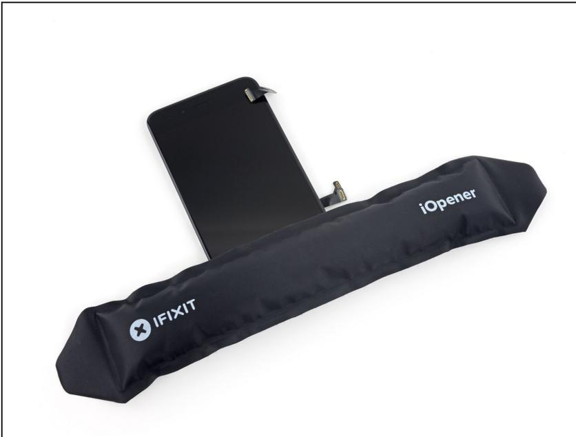
**i** Il riscaldamento dell'area attorno al sensore home/Touch ID aiuta ad ammorbidire l'adesivo che tiene in posizione il suo delicato cavo, rendendo più facile e sicura la rimozione.
