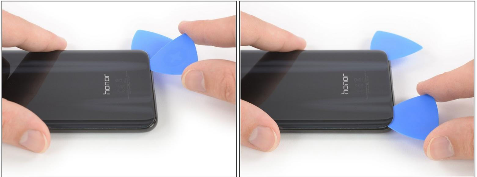
ⓘ [Applica più calore](#) se l'adesivo diventa difficile da tagliare. Durante il processo di rimozione, la cover posteriore è sempre sotto tensione ed è probabile che si rompa se l'adesivo non si ammorbidisce a sufficienza.
