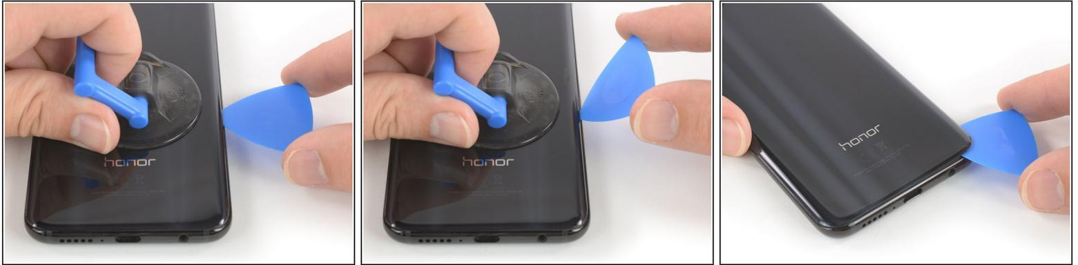
**i** Se il vetro posteriore del telefono è rotto, la ventosa potrebbe non aderire. Prova a [sollevarlo con del nastro adesivo forte](#) o incolla la ventosa in posizione e lascia che si asciughi in modo da poter procedere.
