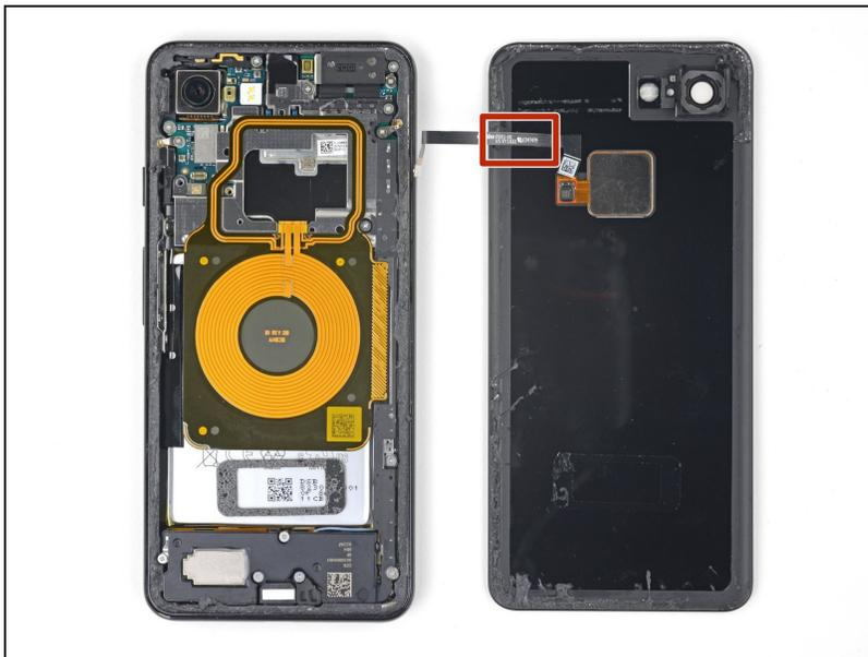
⚠ Mentre infili un plettro sopra il tasto di accensione, stai attento a non infilarlo troppo a fondo, o danneggerai il cavo del sensore delle impronte digitali.
