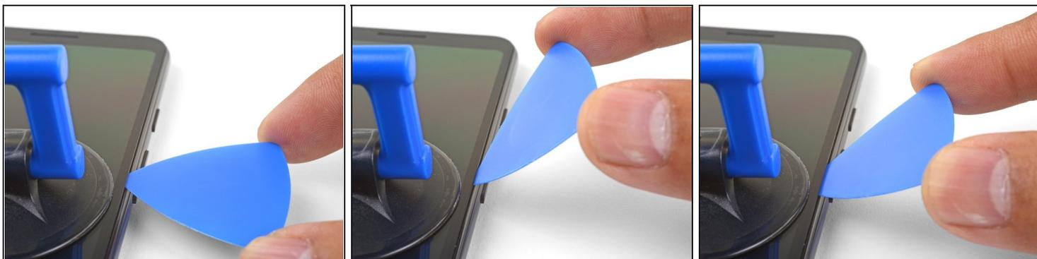
ⓘ Questo passo mostra come inserire il plettro senza danneggiare il pannello OLED. Seguiamo prima di tagliare la colla dei lati lunghi del telefono.
