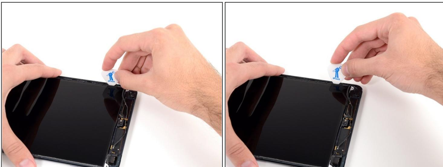
ⓘ Il pannello LCD è incollato alla schermatura di protezione in metallo sul retro del pannello lungo i bordi superiori, destro e sinistro. Per ammorbidire in sicurezza questo adesivo dovrai usare un plettro per spostare di qualche millimetro il pannello LCD a destra e a sinistra più volte.
