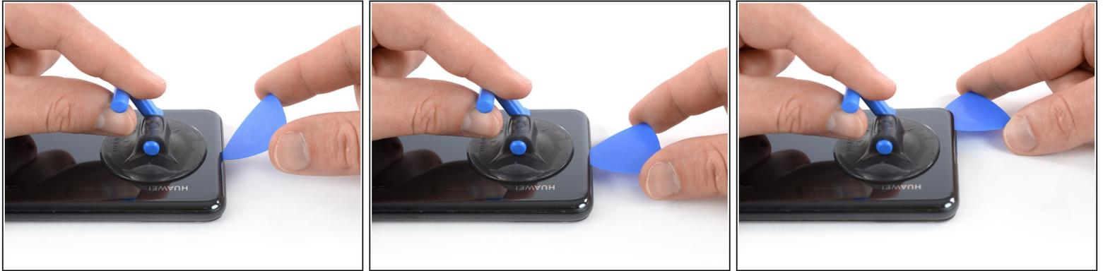
**i** Se il cristallo posteriore del telefono è rotto o crepato, la ventosa potrebbe non aderire bene. Prova a [sollevarlo con del nastro adesivo tenace](#) oppure usa della supercolla (cianoacrilica) per incollare la ventosa in posizione e lasciale il tempo di asciugare prima di procedere.
