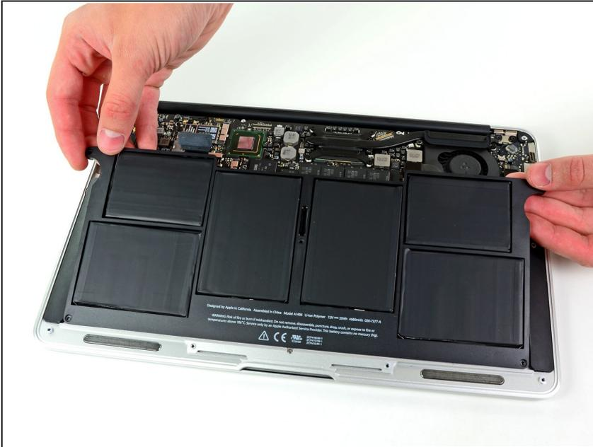
**⚠** Quando lavori con la batteria evita di schiacciare o toccare le sei celle ai polimeri di litio esposte.
