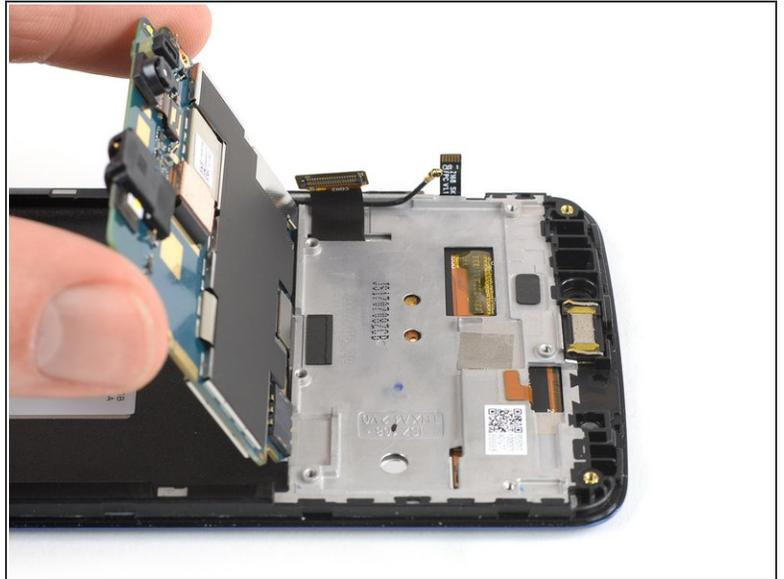
**⚠ Non cercare di rimuovere completamente la scheda madre già ora. Il cavo flessibile di interconnessione è ancora collegato alla sua parte inferiore.**
