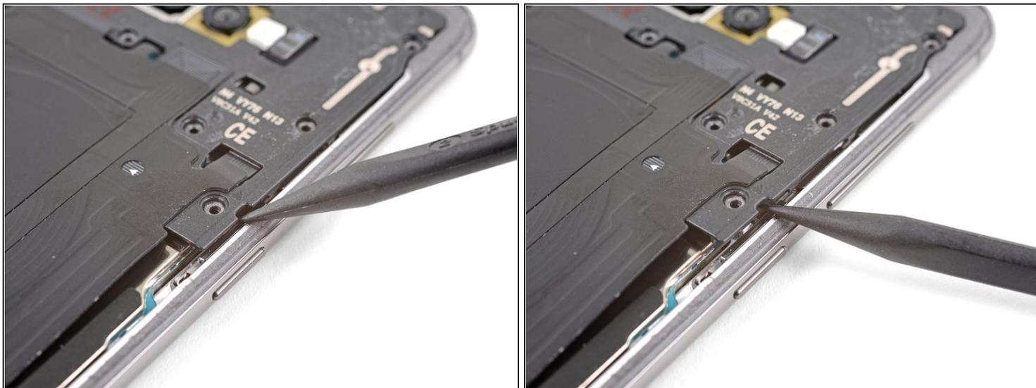
ⓘ Il telaio intermedio resta ancorato da alcune clip in plastica disposte lungo il bordo.
