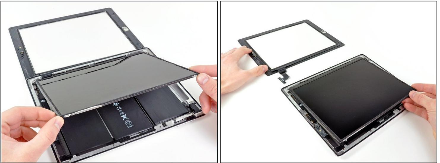
ⓘ Per poter rimuovere il gruppo del pannello anteriore, il cavo a nastro deve passare tra il case e il pannello LCD. Dovrai spostare il pannello LCD per fare spazio.
