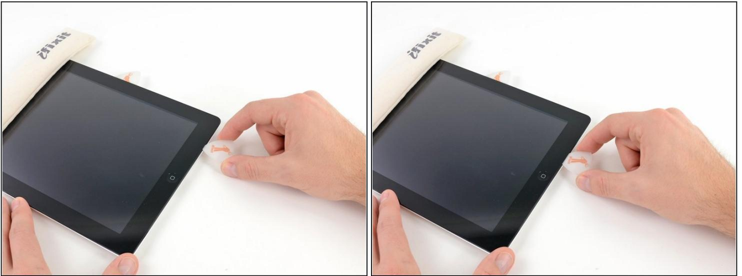
**⚠** Questo passaggio richiede di muovere il plettro sotto il bordo inferiore destro del vetro anteriore. L'antenna WiFi è molto vicina all'angolo e si può strappare facilmente se l'adesivo non viene separato correttamente.
