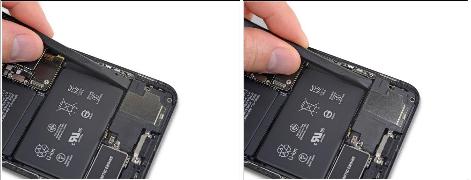
**⚠** Quando fai leva per staccare l'altoparlante, fai attenzione a non danneggiare il cavo flessibile dell'altoparlante che hai appena scollegato. Se necessario, piegalo verso la batteria in modo da lasciare spazio all'estrazione dell'altoparlante.
