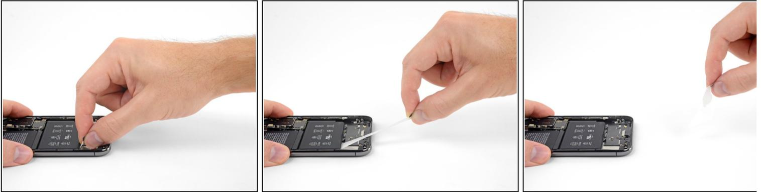
**i** Nei passi successivi, tirerai ciascuna linguetta per allungare la striscia adesiva sotto la batteria. Queste strisce speciali perdono la loro adesività quando vengono allungate; alla fine ti restano in mano, permettendoti di togliere facilmente la batteria.
