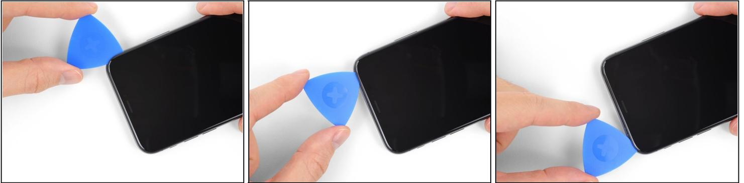
① Il bordo superiore del display è fissato sia con la colla sia con delle clip.
