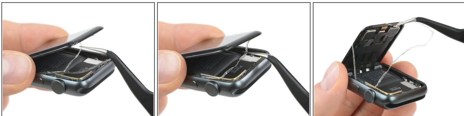
**⚠** Per evitare la forzatura dei cavi dello schermo, aspetta ad aprire completamente il display.
