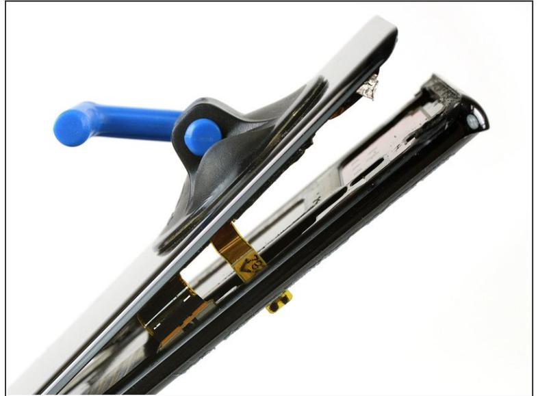
**!** Sia il cavo flessibile touchscreen sia quella del display passano attraverso fori del midframe. Le aperture nel telaio centrale sono piuttosto piccole e può essere un po' complicato far passare i cavi.
