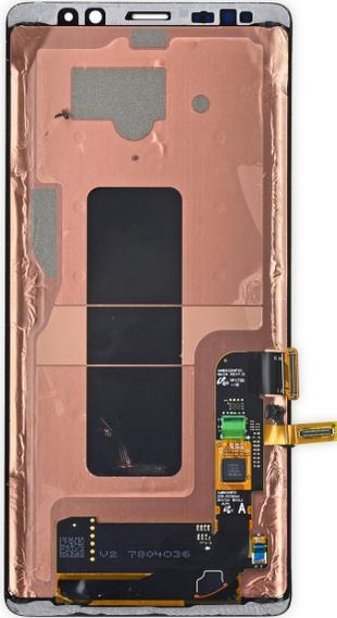
**⚠** Prima di montare un nuovo display, è molto importante rimuovere ogni traccia del vecchio adesivo dal telaio; nel caso il tuo display fosse rotto, presta una particolare cura anche nell'eliminazione dei più piccoli frammenti di vetro.
