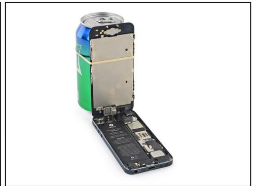
**⚠ Não tente remover completamente o conjunto do painel dianteiro da estrutura traseira, pois há vários cabos planos ainda presos na parte superior do iPhone.**
