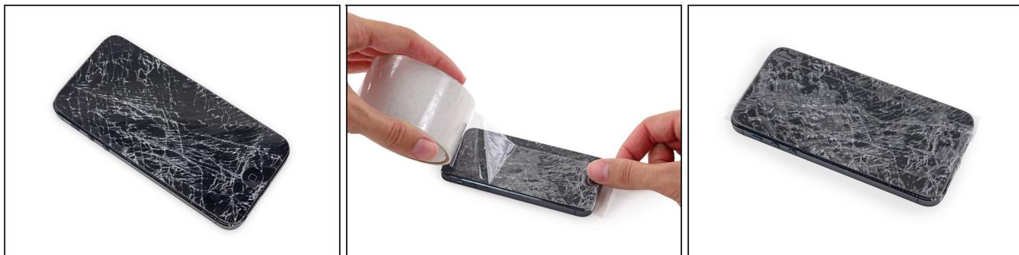
**i** Se il vetro del tuo schermo è crepato, previeni ulteriori rotture ed evita di farti male durante la riparazione disponendo del nastro adesivo sul vetro.
