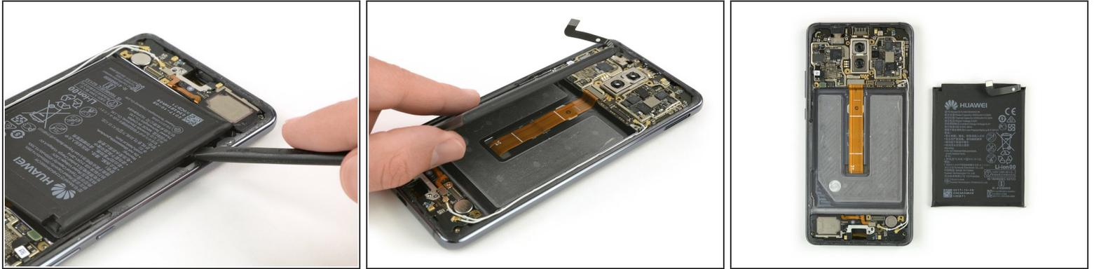
**⚠** Il cavo flex dello schermo passa sotto la batteria. Stai attento a non danneggiarlo quando cerchi di staccare l'adesivo. Cerca anche di non piegare mai o perforare la batteria.
