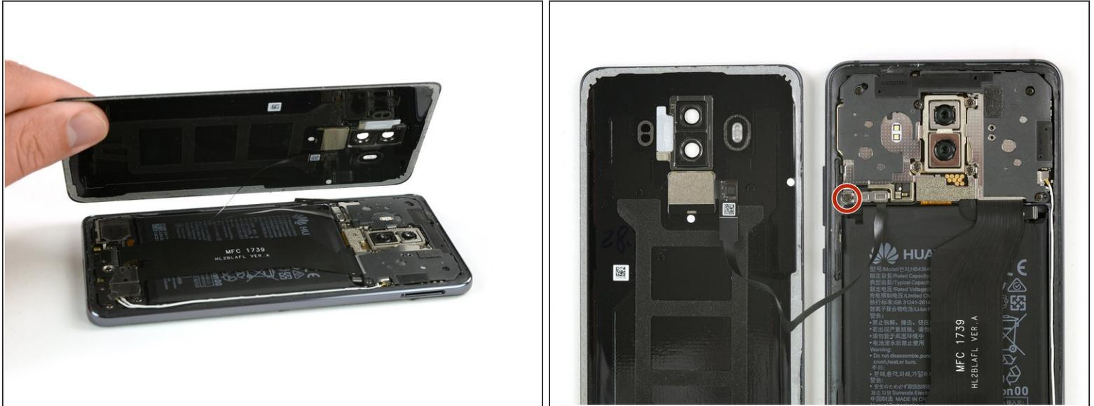
**!** Non cercare di rimuovere completamente la cover posteriore già ora. Il cavo del sensore impronte digitali è ancora collegato alla scheda madre.
