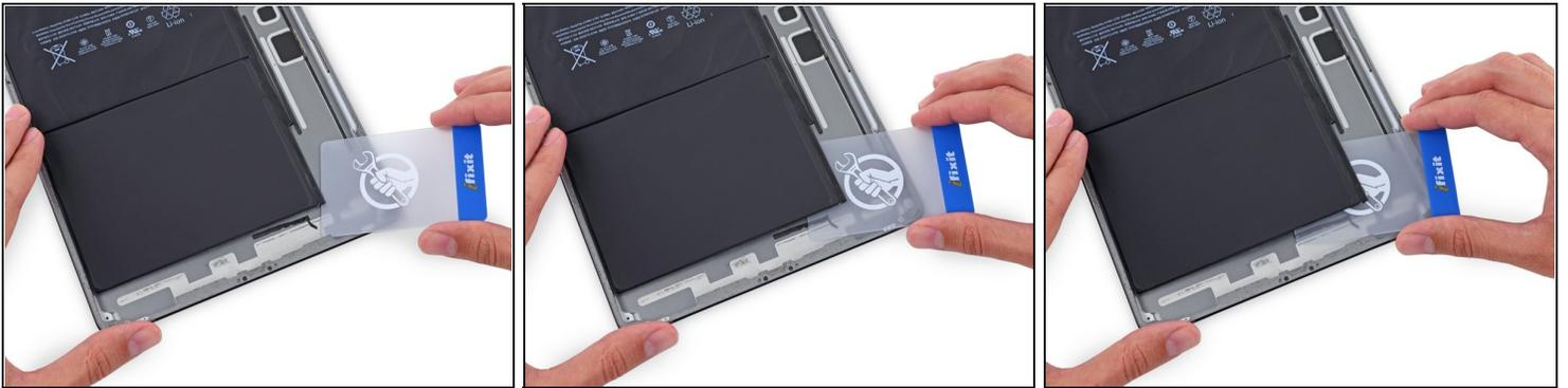
**⚠** Nel corso della seguente procedura, scorrerai una scheda di plastica tra la batteria e il case posteriore dell'iPad, per separare l'adesivo che fissa la batteria. Fai attenzione a mantenere la scheda più piana possibile per evitare di piegare la batteria, ciò potrebbe danneggiarla al punto da rilasciare sostanze chimiche nocive.
