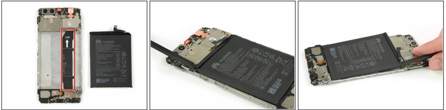
**⚠** Nei passi successivi è importante evitare di piegare o perforare la batteria; un eventuale danneggiamento potrebbe innescare l'incendio della cella.
