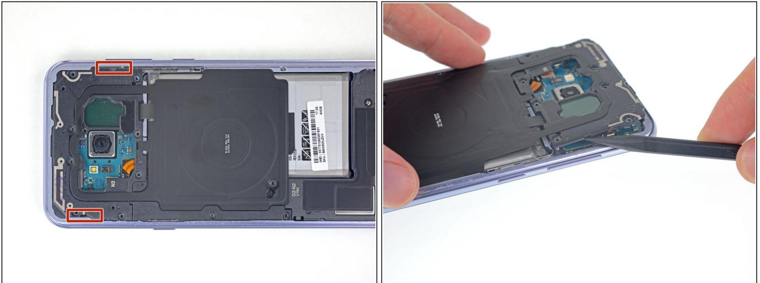
**i** Il gruppo bobina di ricarica wireless + antenna è fissato anche da piccole clip in plastica.
