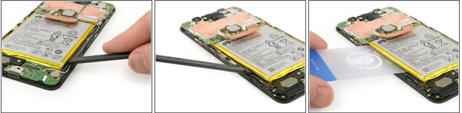
**⚠️ Attenzione: non inserire lo spudger o la scheda di plastica troppo in profondità sotto la batteria. Il cavo del display si trova sotto la batteria.**
