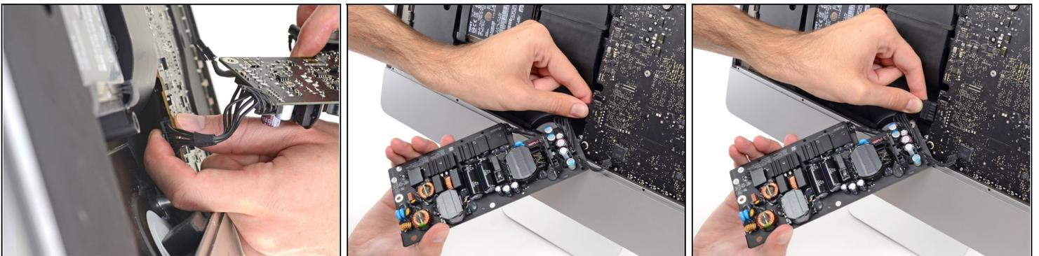
**⚠ Stai molto attento** a non toccare le gambe dei condensatori o qualsiasi saldatura esposta sul retro dell'alimentatore. Tocca la scheda solo sui suoi bordi.
