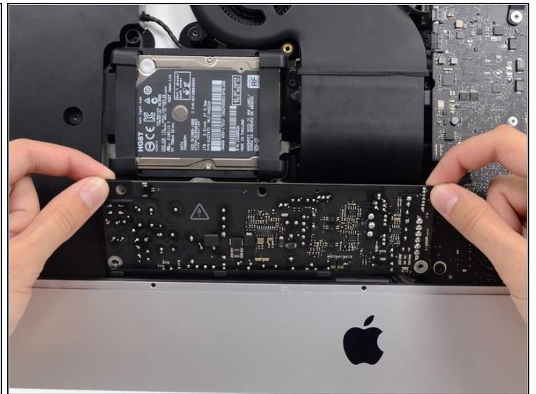
⚠ Mentre lavori sull'alimentatore, **stai molto attento** a non toccare le gambe dei condensatori o qualsiasi saldatura esposta sul retro dell'alimentatore. Tocca la scheda solo sui suoi bordi.
