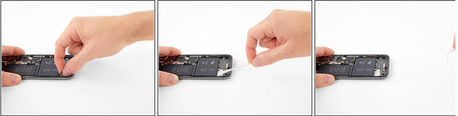
**i** Nei passi successivi tirerai ciascuna linguetta per allungare un po' alla volta le strisce adesive sotto la batteria. Questo nastro speciale smette di aderire quando viene allungato e quindi ti resta in mano. Così potrai sollevare ed estrarre facilmente la batteria.
