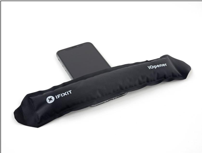
**i** Il riscaldamento del bordo inferiore dell'iPhone aiuta ad ammorbidire l'adesivo che blocca il display, semplificando l'apertura.
