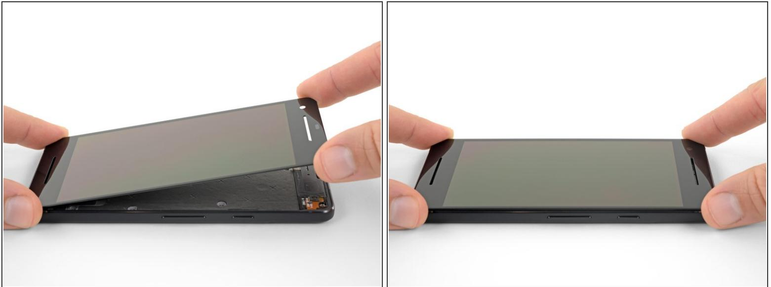
**i** Nel corso di questo passo, this foray temporaneamente il nuovo schermo per allinearlo correttamente con la staffa della fotocamera anteriore mentre fai aderire la staffa stessa allo schermo.
